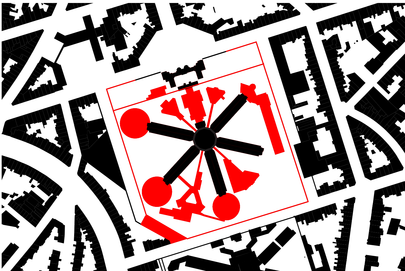
Plans reprenant les démolitions nécessaires (en rouge) en vue de la mise en œuvre du scénario. Certaines démolitions de bâtiments anciens doivent être précisées. Il est par contre certain que le mur d'enceinte, à l'exception de la partie en cours de classement (voir supra), soit démolie.
