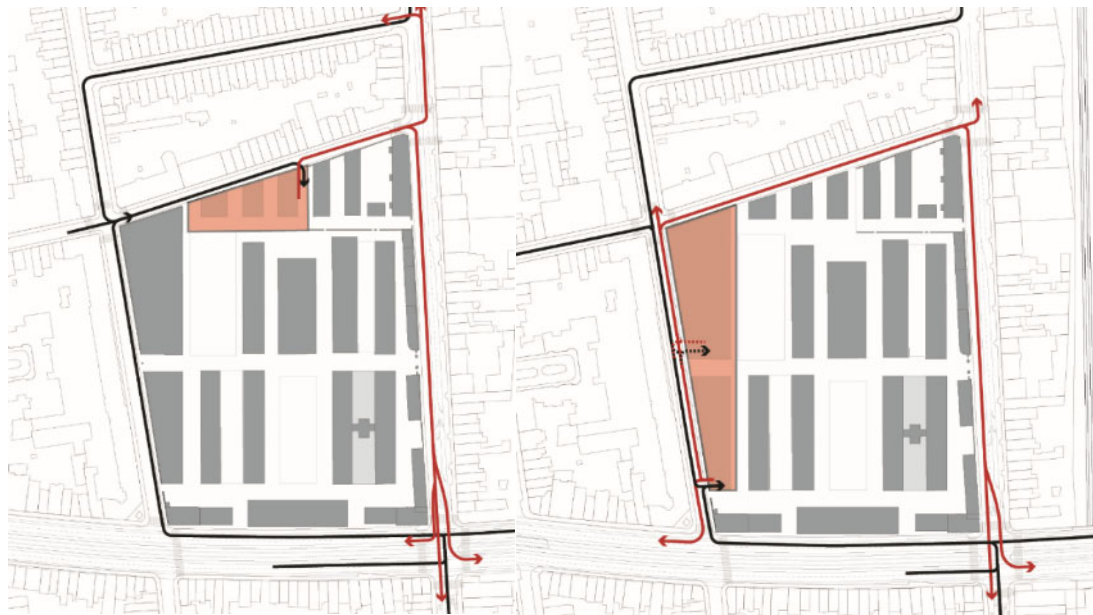
Figuur 160: Voorgestelde configuratie voor de ondergrondse parkings en hun toegangen (BUUR, juni 2018)
