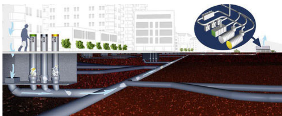
Figuur 331: Ondergrondse schematische voorstelling van een geautomatiseerd pneumatisch inzamelingsysteem. Bron: Association internationale des tunnels et de l'espace souterrain, 2015.
