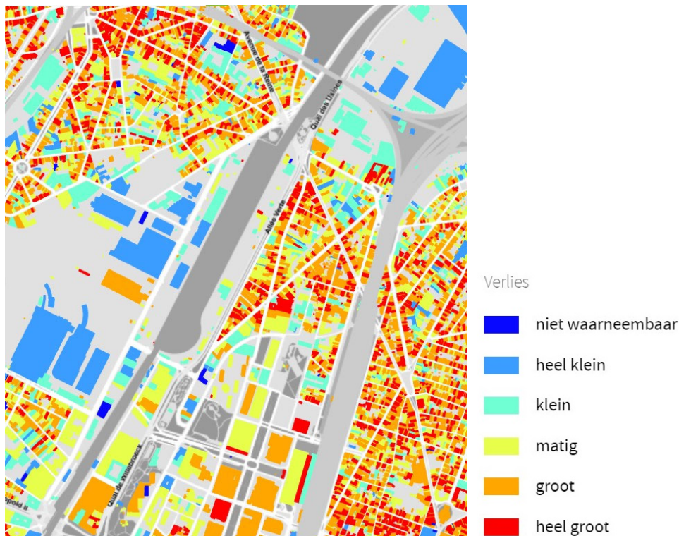
Figuur 19. Thermografisch luchtbeeld van de daken van de gebouwen in TN, 2008. (bron: Leefmilieu Brussel)
