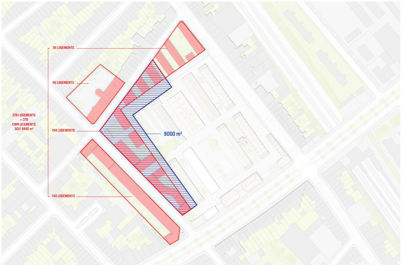
LOCALISATION DES PARKINGS SOUTERRAINS (LES HACHURES BLEUES REPRÉSENTENT L'EMPRISE POTENTIELLE DES PARKINGS SOUTERRAINS, SUR UN NIVEAU -1)
